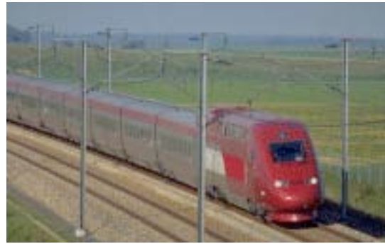
Figure 10.3 : évolution des T.G.V. : Eurostar (12 MW tri-courant) et Thalys (8,8 MW quadri-courant).
