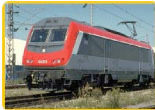
Figure 10.4 : locomotive "universelle" BB 36000 Astride (5,6 MW, 88 tonnes) 4 moteurs asynchrones tri-courants ( 25 kV - 50 Hz ; 3 kV et 1,5 kV continus)
