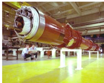
Figure 1.7 : collisionneur de particules RHIC (Relativistic Heavy Ion Collider), tunnel et aimant supraconducteur. ( www.rhic.bnl.gov ).
