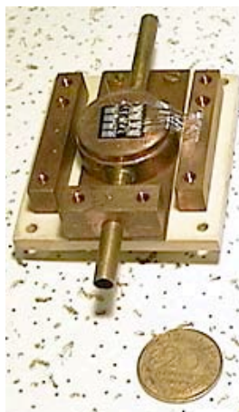
Figure 1.12 : micro-refroidisseur avec échange monophasique de composants de puissance (LEG).
