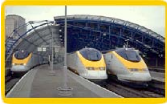
Figure 10.3 : évolution des T.G.V. : Eurostar (12 MW tri-courant) et Thalys (8,8 MW quadri-courant).
