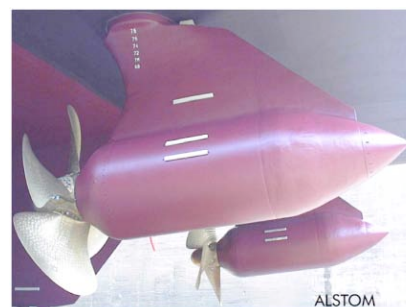
Figure 1.2 : Queen Mary (4 x 19,5 MW) et PODs (2x19,5 MW) du navire "Millenium" (documents Alstom).
