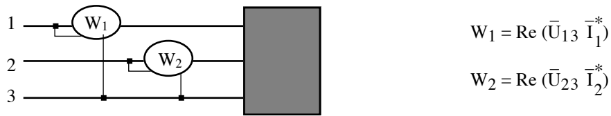
Figure 3.7 : méthode des deux wattmètres.
