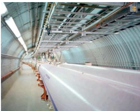
Figure 1.7 : collisionneur de particules RHIC (Relativistic Heavy Ion Collider), tunnel et aimant supraconducteur. ( www.rhic.bnl.gov ).
